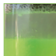
Refrigerante y aditivo con contaminación de agua
